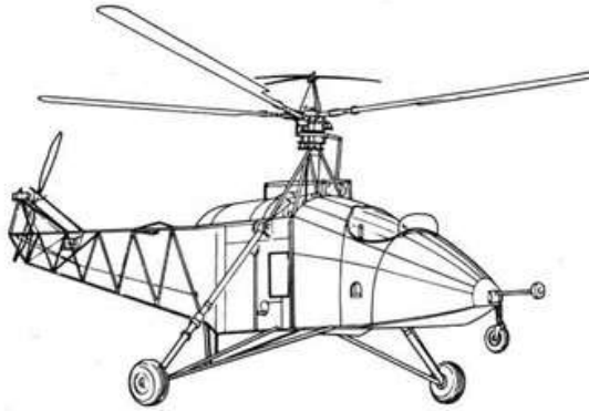
Trục thăng mecanic với cánh quạt đuôi để cân bằng ngẫu lực do cánh quạt chính tạo ra.
